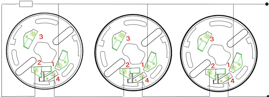
PARA EL AVISADOR DE INCENDIO DE ROTURA DE VIDRIO, debe conectarse igual que en el anterior, siguiendo el conexionada A (normal abierto)
