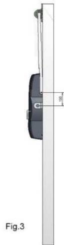
1-Si el motor será fijado en la lateral de la hoja, la línea de la extremidad del eje del motor deberá estar posicionada a 15 mm para fuera de la línea del brazo de articulación del portón.
