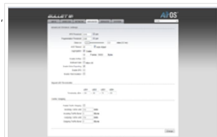
Configuraciones avanzadas en el Bullet M5 (modo Punto de Acceso)
