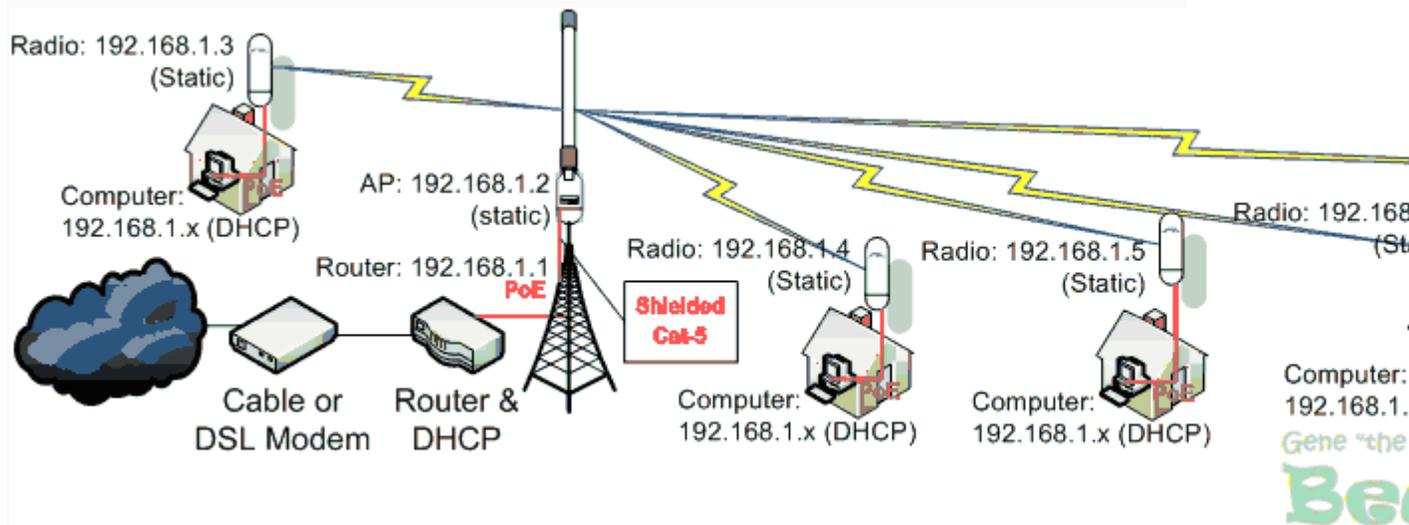
PRIMERO: Instalar un router como se muestra arriba. Configurarlos como un servidor DHCP con un pool IP que es lo suficientemente grande para servir el número de cliente de dispositivos (por ejemplo, ordenadores, impresoras, etc.) necesita servir. Nota: La piscina no debe extenderse inferior a 192.168.1.21. Las instrucciones para hacerlo son diferentes para cada fabricante de router. Consulte la FAQ para ayuda si es necesario.
