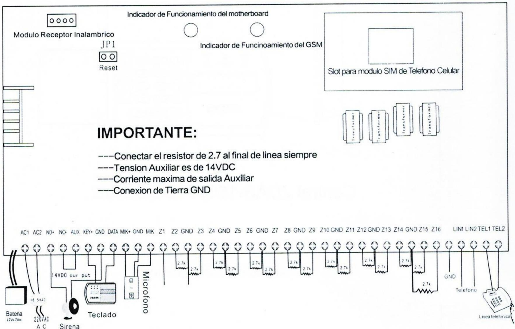
\* Cuando se opera normalmente, la luz indicadora se encenderá. Z1-Z16 son las conexiones de cable de cada zona 1-16.
